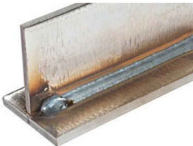
Зварне з'єднання металів
